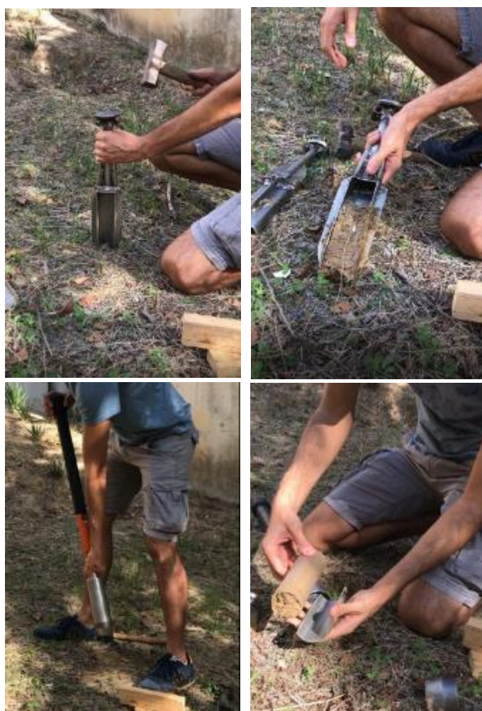
Figura 3-10. Muestreo del suelo con dos tipos diferentes de sacatestigos de sección cuadrada (5 x 5 cm de lado) o circular (5 cm de diámetro) de 15 cm de longitud. Ambos tipos de sacatestigos pueden abrirse longitudinalmente para obtener muestras de suelo inalterado de volumen constante conocido.
