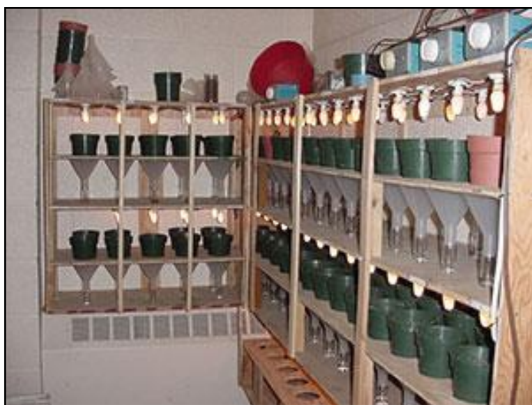
Figura 3-12. Embudos de Berlese utilizados para extraer microartrópodos de muestras de suelo inalterado. Fuente http://soilbugs.massey.ac.nz/collection_berlese.php
