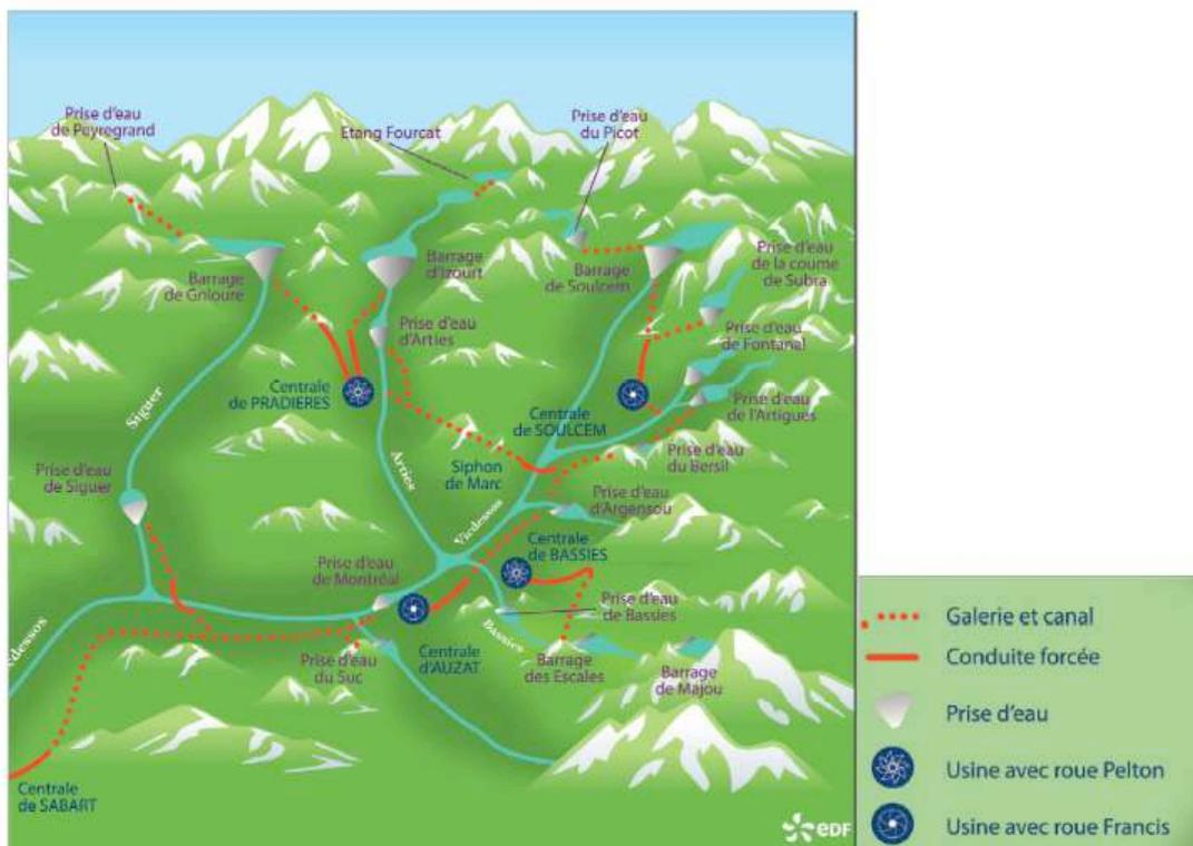
Figura 8.4: Sistema hidroeléctrico de Auzat.
